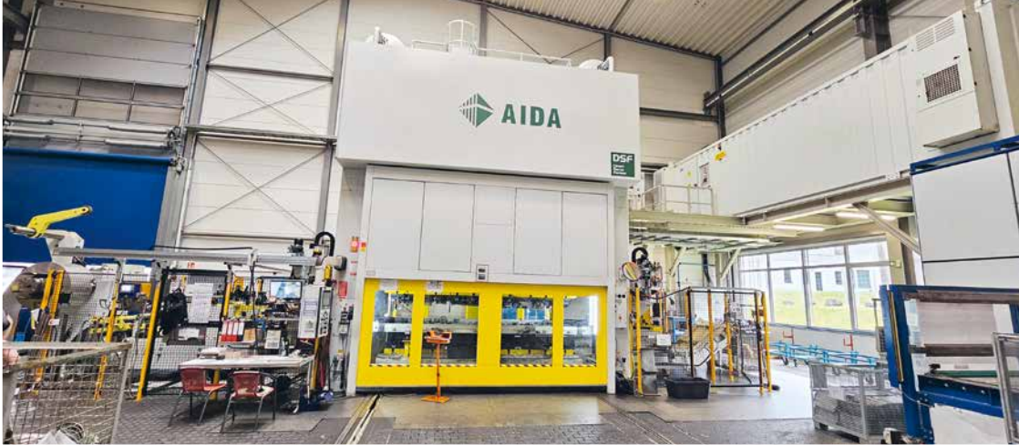
800-t-Pressen 'Aida' der BK Stanz- und Umformtechnik
