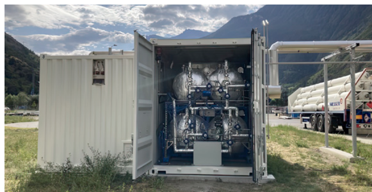
Weltweit erster thermischer H 2 -Verdichter: effiziente, stromfreie Trailerbefüllung für nachhaltige Wasserstofflogistik
